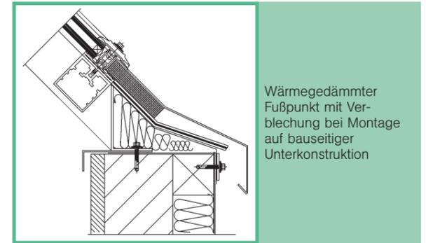
Wärmegeämmteter Fußpunkt mit Verblechung bei Montage auf bauseitiger Unterkonstruktion
